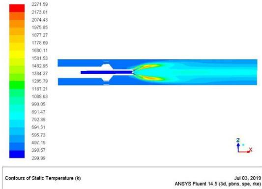
FIGURE 18: STATIC TEMPERATURE (°A).
