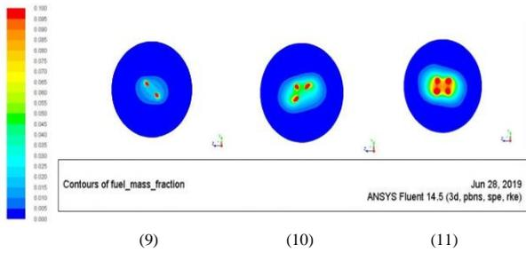
**FIGURE 9:** FUEL MASS FRACTION ('A').
