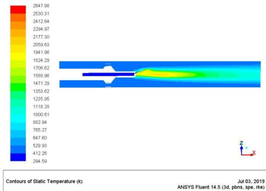
FIGURE 19: STATIC TEMPERATURE (°B).
