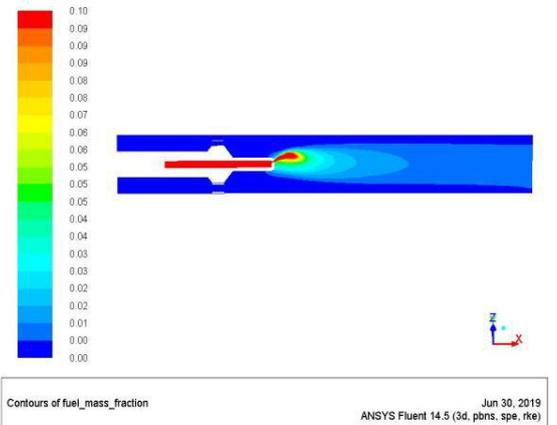
**FIGURE 16:** FUEL MASS FRACTION ('B').
