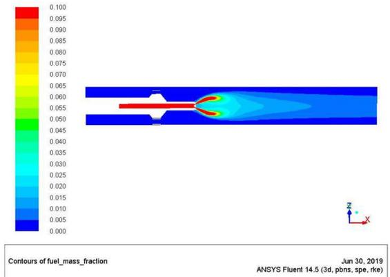
**FIGURE 15:** FUEL MASS FRACTION ('A').
